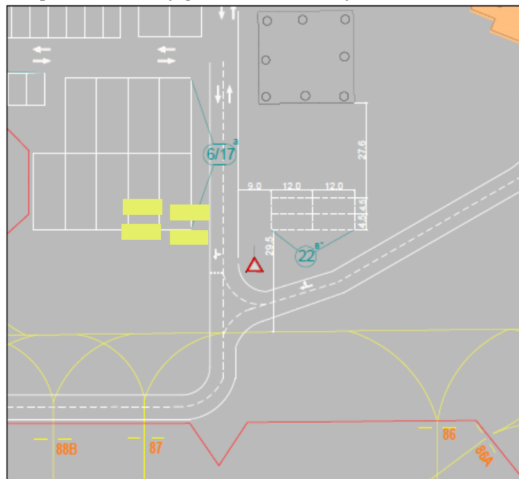
Рисунок Н.1.16. Схема оперативного размещения деайсеров в районе МС № 11 Figure M.1.16. Operational configuration scheme of deicers in the area of PL No. 11
